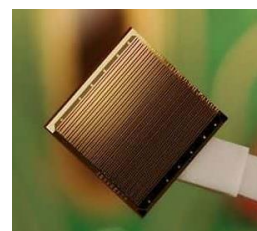
Sur une puce de quelques millimètres, Intel parvient à graver des dizaines de lasers. Crédits : Intel
