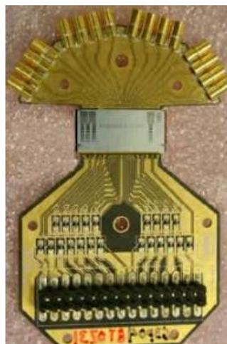
Les signaux électriques sont dirigés vers les modulateurs (la surface grise), uniquement faite de silicium, codés sous forme lumineuse et envoyés aux connecteurs optiques. © Intel
